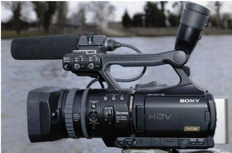
Sony, sur ce caméscope, a décidé d'abandonner le TRI CCD 1/3 pouce bien connu des modèles HDR-FX1 et HDR-Z1 pour innover avec un TRI Cmos 1/4p (4,5mm) de 1 037 000 pixels effectifs en mode 16/9 et 778 000 pixels en mode 4/3.
