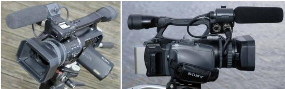
La grande nouveauté due au Cmos de Sony, c'est la possibilité de passer en 25P au niveau du capteur ce qui permet donc d'offrir le 1080i 50 classique et un 1080i 25 PSF qui n'est bien sûr pas un 1080P beaucoup plus complexe à enregistrer à cause du débit nécessaire.
