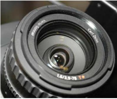
L'optique n'a pas non plus été négligée avec un objectif HD Vario Sonnar 20X de  $f = 3.9$  à  $78 \text{ mm}$  ( $f = 37.4$  to  $748 \text{ mm}$  en  $16:9$  équivalent  $24 \times 36$ ) ouvrant à  $1.6 / 3.9$  et pourvue d'un diamètre de filtre de  $62 \text{ mm}$
